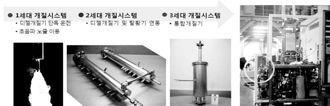
그림 4. 디젤 개질 시스템 개발 과정
